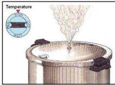
7. Coloque el contrapeso o el regulador de peso en el tubo de ventilación, o cierre la válvula de escape para presurizar la olla.
