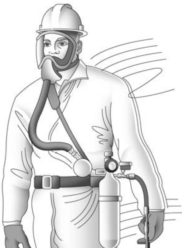
Figura 12.13. Equipo de respiración con manga de aire con cilindro de escape auxiliar. (Crédito: OSHA)
