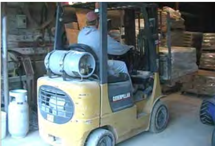
Figura 7.1. Los motores de combustión, como el motor de propano de esta carretilla elevadora, emiten monóxido de carbono, óxidos de nitrógeno y otros gases peligrosos en edificios y remolques mal ventilados.
