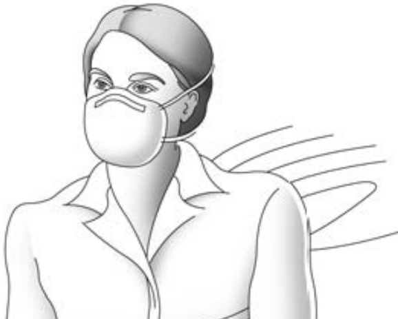
Figura 12.1. Respirador con máscara filtrante. (Crédito: OSHA)
