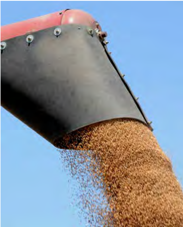
Figura 13.5. Los transportadores mecánicos pueden reducir la exposición de los trabajadores al polvo agrícola.
