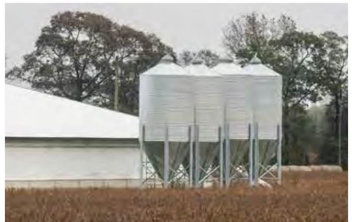
Figura 11.5. Un espacio confinado puede requerir permiso si tiene un fondo en forma de embudo donde un trabajador podría atascarse, como estos contenedores con fondo de tolva. (Crédito: USDA)
