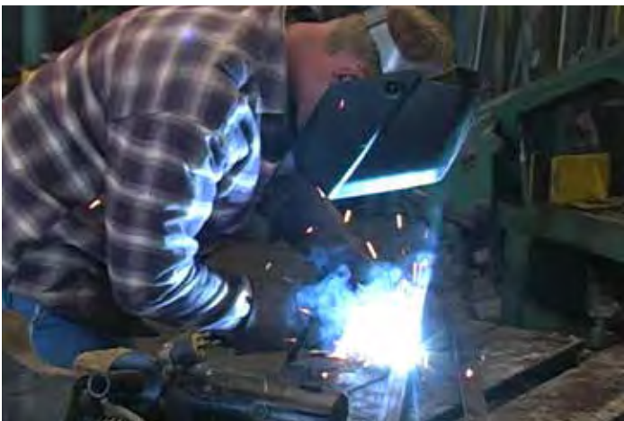
Figura 8.1. La soldadura, el corte con soplete y otros trabajos en caliente exponen a los agricultores a diversos humos y gases. Algunos pueden ser dañinos, especialmente en áreas mal ventiladas.
