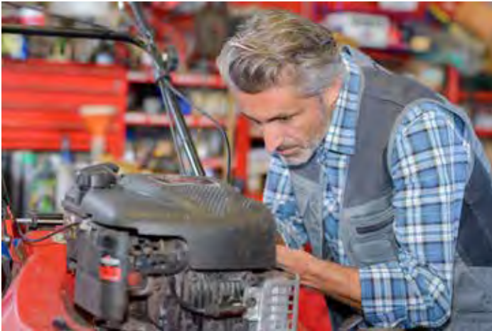
Figura 7.4. Los motores pequeños pueden crear niveles peligrosos de monóxido de carbono mientras funcionan en talleres de reparación y otros espacios interiores.
