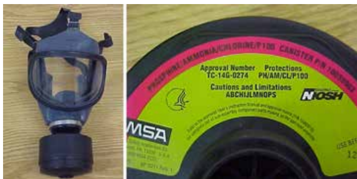
Figura 12.4. La máscara antigás (izquierda), con un primer plano de la etiqueta de la lata, proporciona una protección limitada contra la fosfina, el amoníaco, el cloro y las partículas (derecha).
