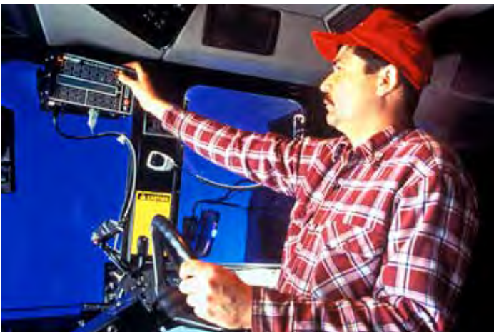
Figura 2.11. Mantenga los sistemas de filtración de aire para mantener el polvo fuera de las cabinas de los equipos.
