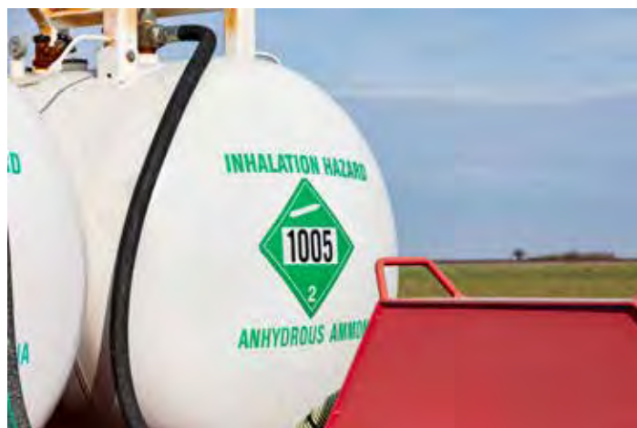
Figura 6.3. Use equipo de protección y siga las instrucciones del fabricante del tanque al colocar o quitar mangueras de amoníaco anhidro.
