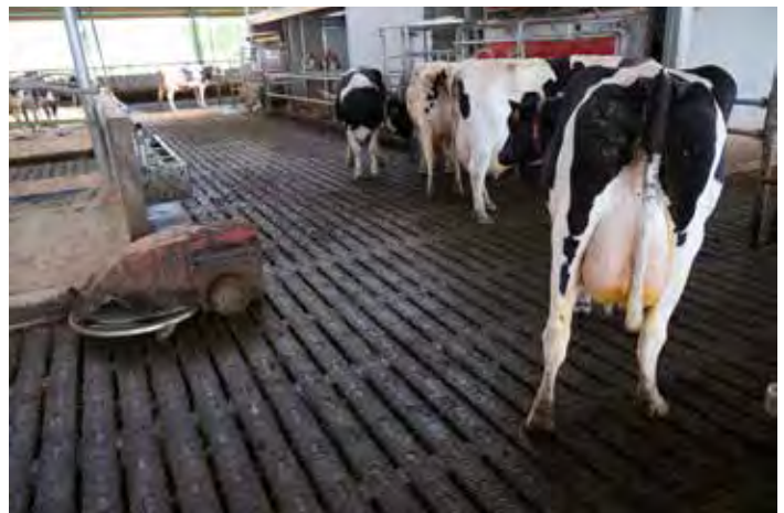
Figura 2.13. Los limpiadores robóticos ayudan a mantener limpios los pisos de los graneros.
