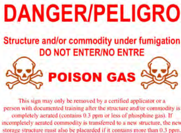
Figura 4.7. No abra puertas ni retire lonas si ve este letrero colocado cerca del grano almacenado, a menos que sea un manipulador de pesticidas capacitado con el equipo de protección adecuado.
