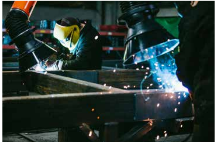
Figura 8.4. Las campanas extractoras locales eliminan los humos de soldadura y ayudan a mantener limpio el aire del lugar de trabajo.
