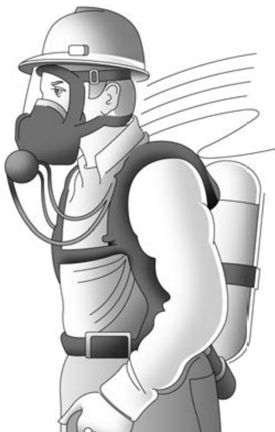
Figura 12.14. Equipo de respiración autocontenido (SCBA). (Crédito: OSHA)
