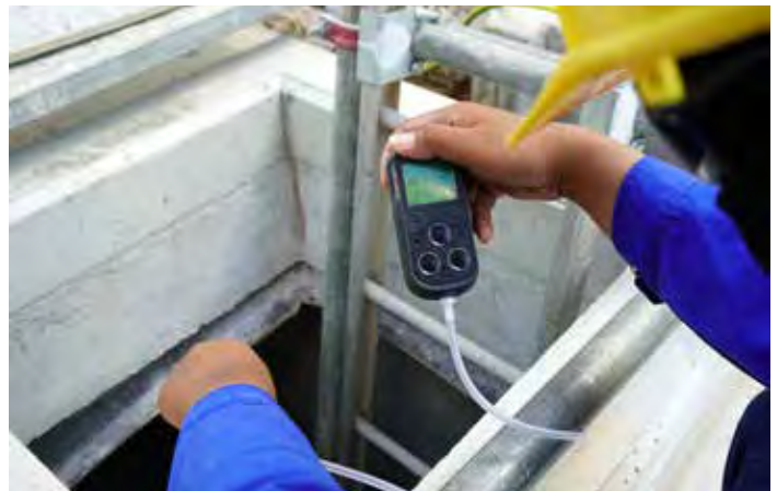
Figura 11.9. Monitoree el aire antes y durante la entrada a espacios confinados que requieren permiso.
