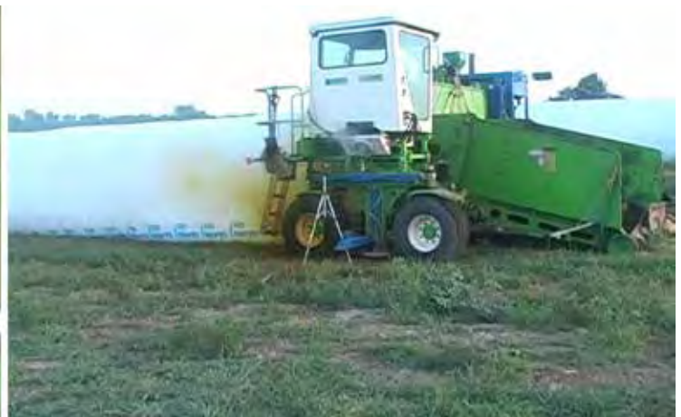
Figura 4.14. No deje las embolsadoras de ensilaje unidas a las bolsas durante la noche o durante los descansos largos. El monitor de aire de la izquierda muestra una concentración mortal de 20 partes por millón (20 ppm) de dióxido de nitrógeno cerca de la entrada de la embolsadora. Como referencia, las concentraciones de dióxido de nitrógeno de solo 13 ppm inmediatamente se consideran peligrosas para la vida y la salud (IDLH).
