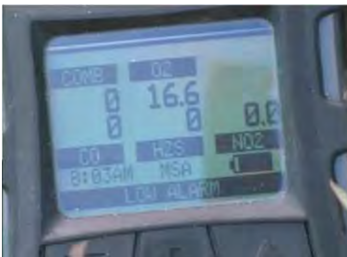
Figura 4.6. El monitor de gas de la izquierda muestra solo un 16,6% de oxígeno en el aire de la estructura de agua de riego de la derecha. El aire normal contiene entre un 20% y un 21% de oxígeno. Las concentraciones por debajo del 19,5% son deficientes en oxígeno y potencialmente peligrosas.
