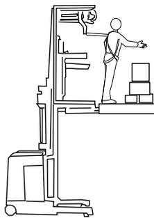
tienen una plataforma para elevar al operario al nivel de los materiales almacenados. Los operarios se paran en la plataforma para alcanzar desde los palés (plataformas) sin tener que bajar el palé al nivel del suelo. Los seleccionadores de orden de gran altura usualmente son movidos por motores eléctricos y están equipados con retenedores de seguridad para evitar que el operario se caiga.
