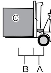
$$(A + B) \times C = \text{Capacidad de carga del diseño}$$
